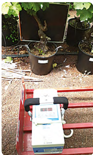
Le dispositif d'essai de radiographie 2D en serre
