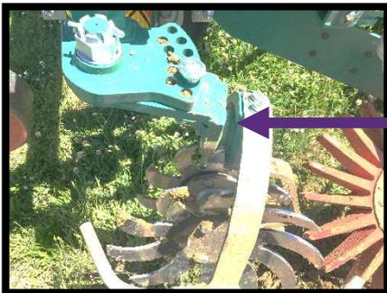
Réglage fin de l'inclinaison grâce aux crantages multiples
