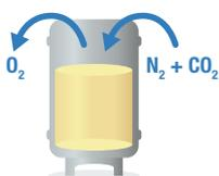
Lors d'une dissolution exceptionnelle d' $\text{O}_2$  des moyens de désoxygénation existent en action curative. Il s'agit d'injecter de l'azote ou du  $\text{CO}_2$  ou un mélange azote/ $\text{CO}_2$  en fonction de la teneur du vin en  $\text{CO}_2$ . Cette méthode doit néanmoins être maîtrisée afin de gérer la décarbonation et d'éviter les pertes aromatiques.
