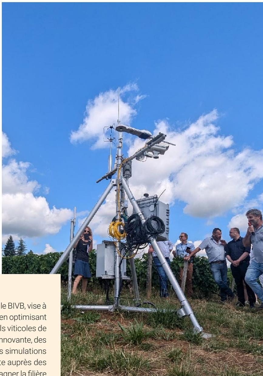
La tour à flux installée à Rully, mesure les échanges de gaz entre la vigne et l'atmosphère, notamment le dioxyde de carbone (CO<sub>2</sub>) et la vapeur d'eau à l'échelle de la parcelle. Elle capte en continu les flux de CO<sub>2</sub> pour évaluer la photosynthèse et la respiration de l'écosystème viticole.
