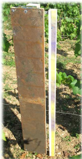
Plaque de fer rouillée et papiers hydro-sensibles
