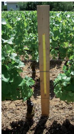
► L'inclinomètre permet d'effectuer un réglage des angles diffuseurs identiques sur toutes les descentes. Une bande verticale de papiers hydrosensibles est particulièrement adaptée pour affiner rapidement les réglages du Berthoud CG-Expert
