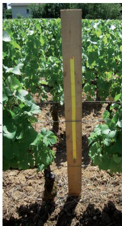
➤ Une **bande verticale** de papiers hydrosensibles et une **plaque noire** sont particulièrement adaptés pour affiner rapidement les réglages des turbines aéro-convectrices.
