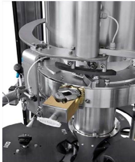
Tiroir de mors sur la boucheuse
